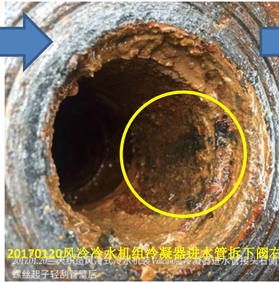
20170221风冷冷水机组冷凝器进水管拆下阀右
